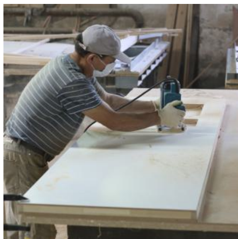
02 Фрезеровка Формирование профиля
